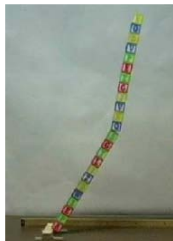
Obr.1a, b, c Padajúci komín. Tyčový model komína. Padajúca veža kociek, pevne spojených k základni.
