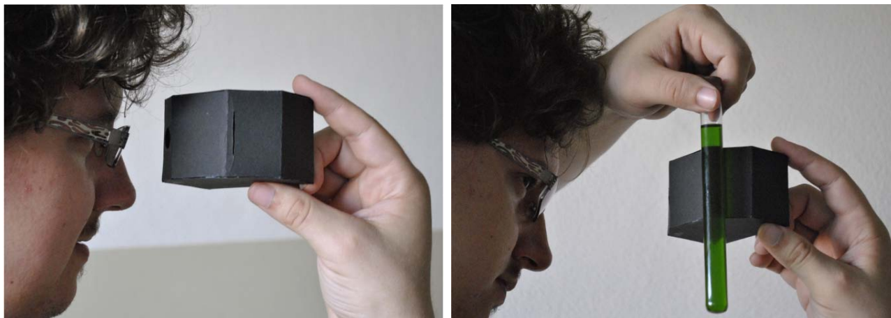
Obr. 1 vľavo: Pozorovanie spektra bieleho svetla; vpravo: Pozorovanie absorpčného spektra vzorky
