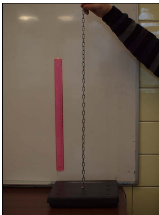
Obr.7: Aparatúra na meranie tiaže padajúcej reťaze
