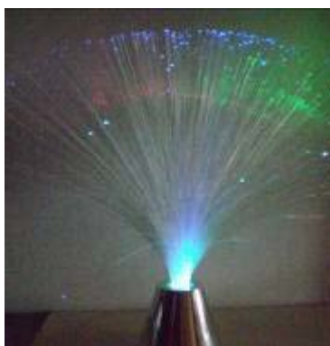
Obr.11: Dekoračná lampa z troch farebných LED diód a zväzku optických vlákien
