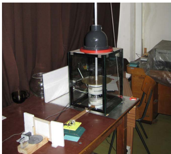
Obr. 6: Celkový záber meracej aparatury. Fáza (natočenie torzného kyvadla) je určovaná odklonom laserového lúča po odraze od plochého zrkadla, upevneného na osi kyvadla a zaznamenanie stopy na tienidle pomocou web kamery (v popredí).
